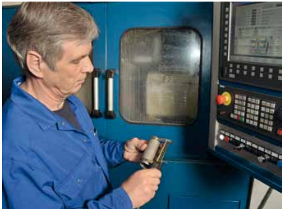
Hitsattu holkki, joka antaa ketjulle 40 prosenttia enemmän kestävyyttä.
